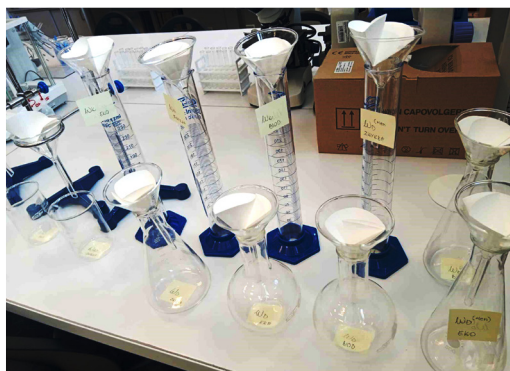
Zdjęcie 2 – przygotowanie zestawu do sączenia roztworów
